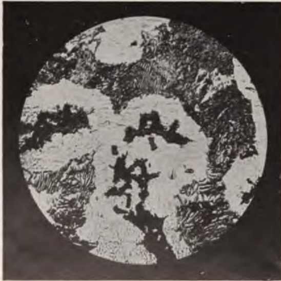
Fig. 147. Material wie Fig. 146. Temperkohle, Ferrit, Perlit.
